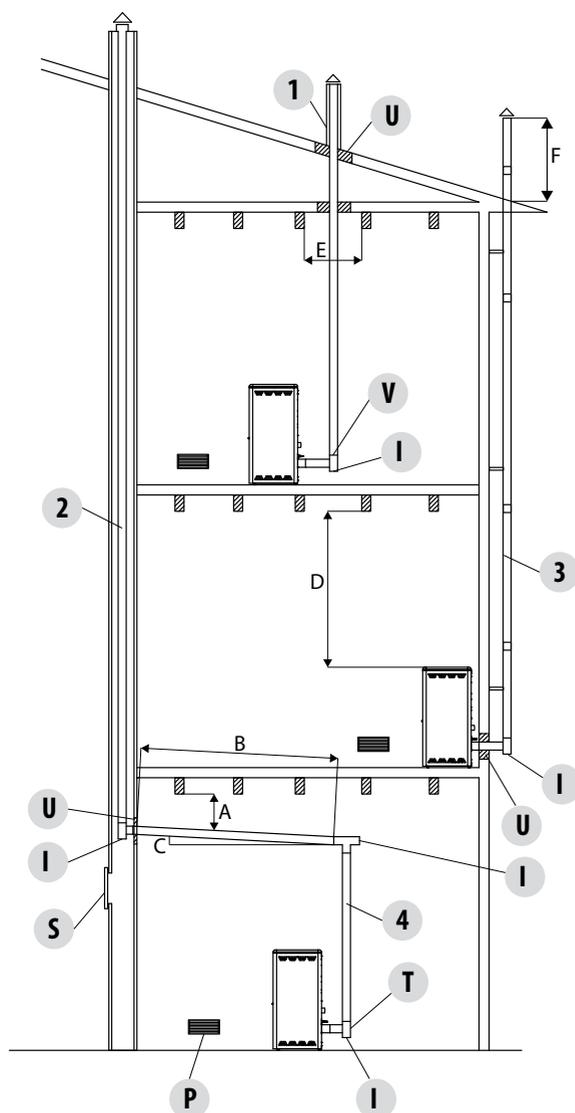
1. Installazione canna fumaria  $\varnothing 150\text{mm}$  con foratura per il passaggio del tubo maggiorata di: minimo 100mm attorno al tubo se comunicante con parti non infiammabili come cemento, mattoni, ecc.; oppure minimo 300mm attorno al tubo (o quanto prescritto nei dati targa) se comunicante con parti infiammabili come legno ecc.
