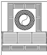
Camino in acciaio AISI 316 con doppia camera isolata con fibra ceramica o equivalente resistente a 400°C.
