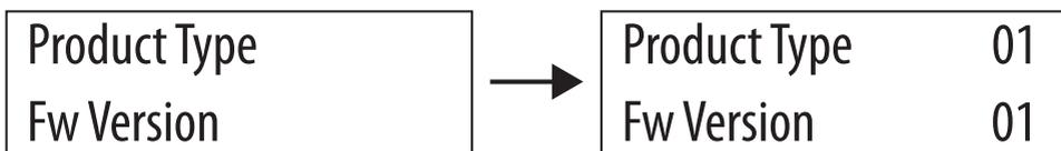
Appena la stufa sarà alimentata sul display comparirà la scritta "Product Type" e "Firmware Version" lampeggianti per alcuni secondi, finché automaticamente non avrà eseguito tutti i controlli poi apparirà senza più lampeggiare il valore di fabbrica impostato. A questo punto la stufa proporrà la prima schermata di utilizzo delle funzioni.
